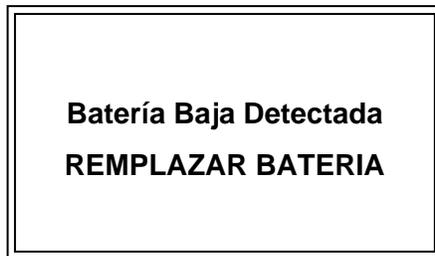
Si durante el proceso de grabación, el grabador GBI-3SM llegase a detectar un nivel de tensión de la batería que le impida su normal funcionamiento, el equipo detendrá la grabación y mostrará el siguiente mensaje:
